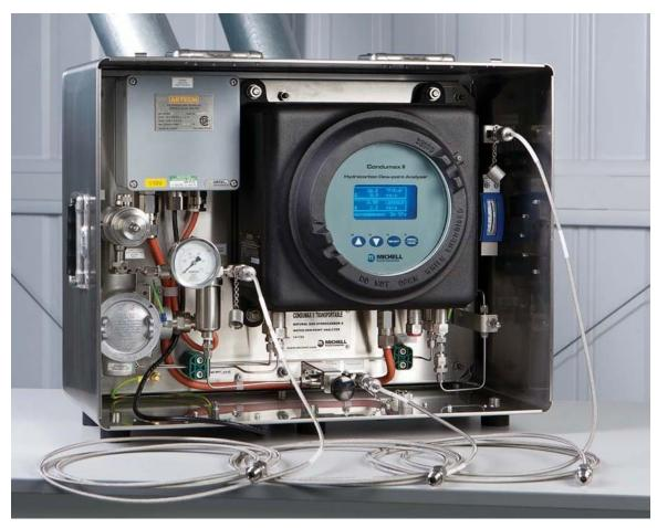
完整的移动式天然气露点分析系统可在现场取样测量。现场测量期间需放置在一个恒温的分析小屋。测量结果和 操作功能都具有完整的数字显示,并且触摸屏可记录露点数据方便操作者查看。
